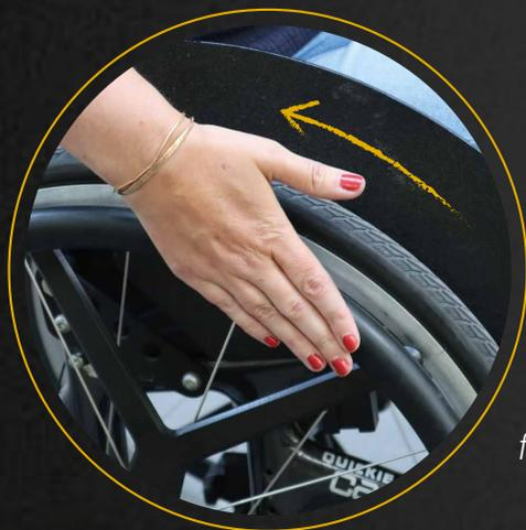
Pour actionner le frein, il suffit d'exercer une faible pression vers l'arrière sur la main courante.
